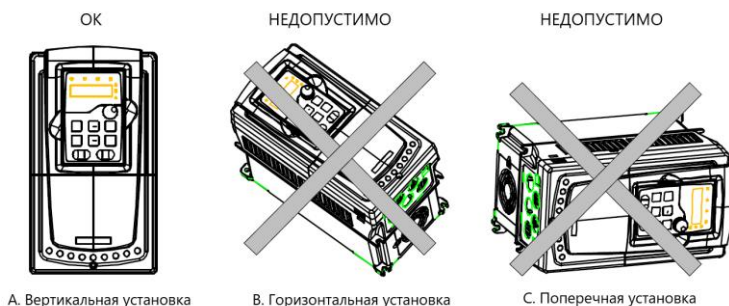
Рис. 4-1 Направление установки
